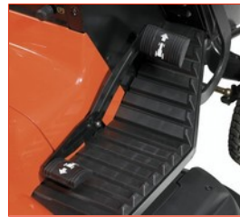
Hydrostatisches Automatikgetriebe - komfortabel dank Fußpedalsteuerung
