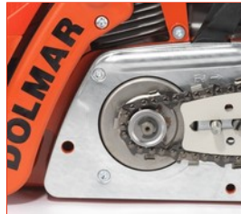
Außenliegendes Kettenrad für einfache Kettenmontage
