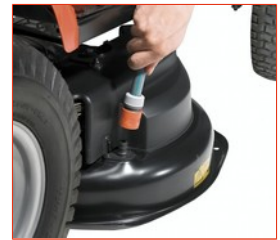
Wasseranschluß für die einfache Reinigung des Mähwerks
