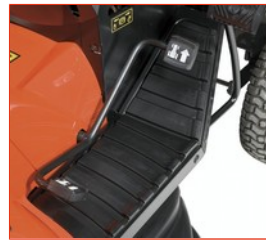
Stufenloses Hydrostatikgetriebe mit unkomplizierter Fußhebelbedienung und Rückwärtsfahrt.
