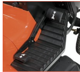
Hydrostatisches Automatikgetriebe - komfortabel dank Fußpedalsteuerung
